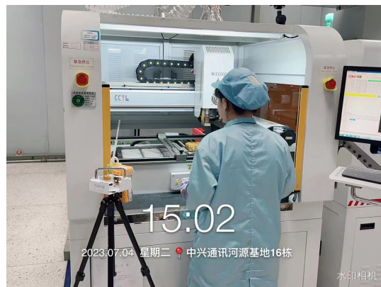
现场定点有机物采样
